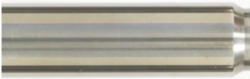
Rys. 6. Kolor powierzchni śruby świadczący o występowaniu powłoki ochronnej.
