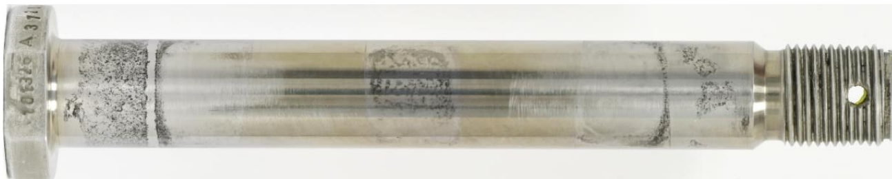
Rys. 1. Przykładowa postać korozji powierzchniowej i wżerowej.
